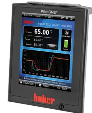
Термостаты оснащены инновационным блоком управления Pilot ONE с цветным сенсорным дисплеем 5.7" и удобным меню на русском языке. Важнейшие параметры процесса отражаются на дисплее, изменения температуры представлены в графическом режиме в реальном времени. Встроенные USB- и Ethernet-выходы делают возможным подключение термостата к ПК или внутренним сетям с целью осуществления дистанционного управления и регистрации полученных данных.
